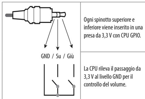
Ogni spinotto superiore e inferiore viene inserito in una presa da 3,3 V con CPU GPIO.
