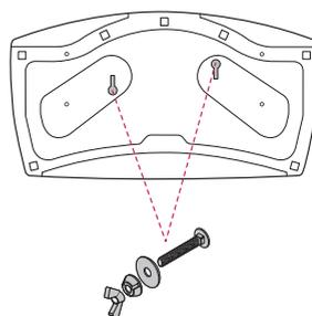
2 Viti per il fissaggio del supporto,
