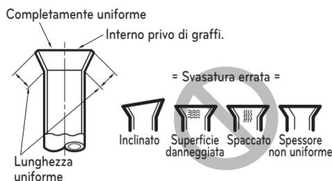
**Forma della svasatura e coppia di fissaggio del dado svasato**
