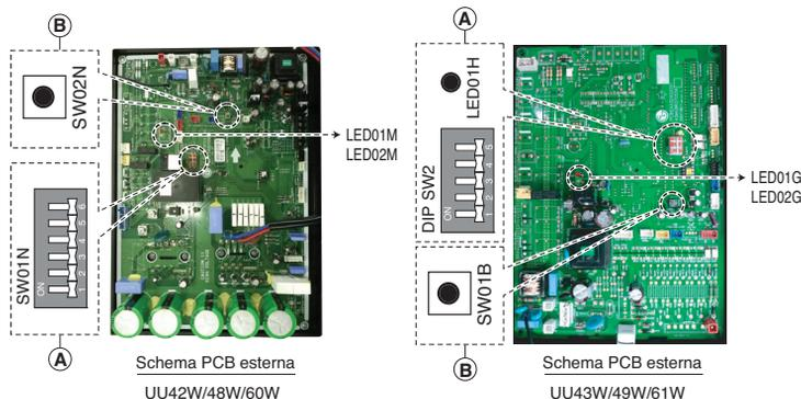
4) Dopo aver eseguito il passaggio 3), il LED01M/G (ROSSO) e LED02M/G (VERDE) lampeggia rapidamente. Ultimata la procedura di indirizzamento, il LED (LED01M/G) verde si spegne, oppure smette di lampeggiare e resta acceso a luce fissa. L'indirizzo di ciascuna unità interna viene indicato sulla finestra del display del telecomando cablato (CH01, CH02, CH03, CH04)
