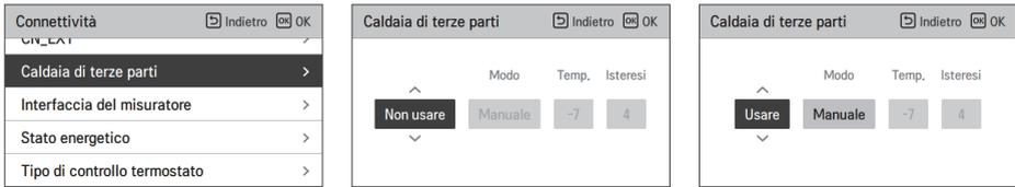
Se lo stato della presente funzione è "Usare", sarà possibile scegliere la modalità di controllo della caldaia, Auto o Manuale.
