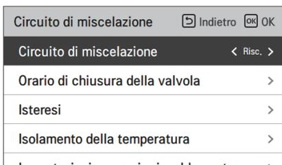
È possibile impostare il tempo di chiusura della valvola[e] e la temperatura di isteresi[°C] sullo schermo da soli. L'impostazione della temperatura di spegnimento protegge l'acqua dal superamento della temperatura di spegnimento nel circuito di miscelazione durante il funzionamento di riscaldamento.
