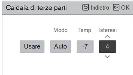
Come mostrato qui sopra, dopo che ogni impostazione è stata completata in modalità installatore, l'opzione caldaia di terze parti viene attivata nell'elenco delle funzioni.
