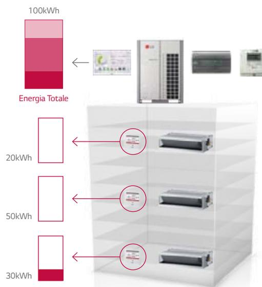
\* L'energia elettrica totale è la somma dell'energia elettrica assorbita dall'unità esterna + energia elettrica assorbita dalle unità interne. Solo nel caso in cui sia installato un controllo centralizzato ed un PDI correttamente configurato con i wattmetri sarà possibile visualizzare i consumi energetici sui comandi remoti. Solo con il comando Premium e Standard 3 sarà possibile visualizzare i consumi.
