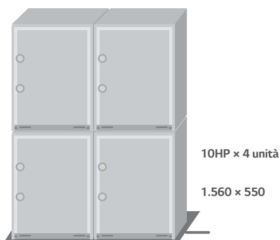
\* Ipotesi di installazione di un sistema 40 HP, composto da unità da 10 HP
