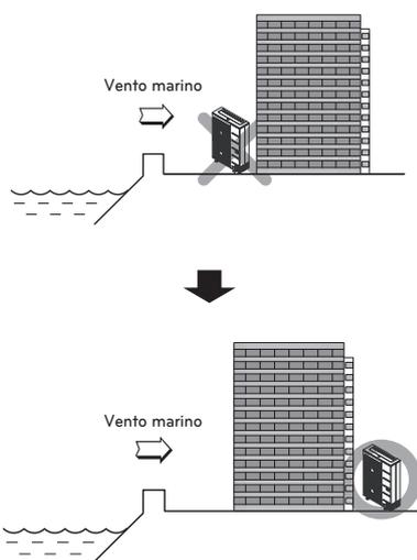
Nel caso l'unità esterna debba essere installata sulla riva del mare, montare un telo di protezione in modo che non sia esposta al vento diretto del mare.
