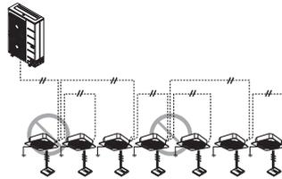
**Esempio) Collegamento di cavo di alimentazione e comunicazione**
