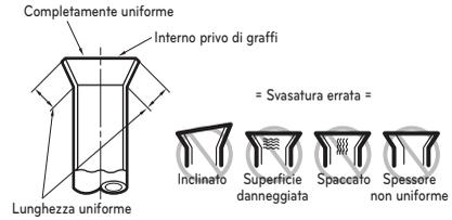
**Connessione delle tubature - Esterno**
