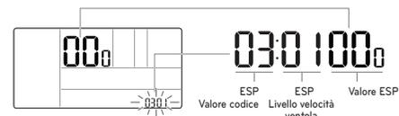
Selezionare il livello di velocità ventola ESP utilizzando il tasto . Ci sono 5 livelli di velocità ventola, MINIMA → BASSO → MEDIA → ALTO → SUPER.
