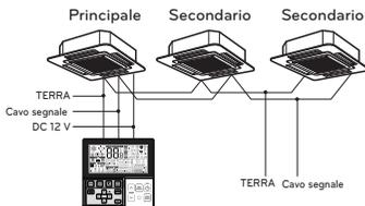
Quando si controllano più unità interne con funzione event communication con un solo telecomando, cambiare l'impostazione principale / secondario dall'unità interna.
