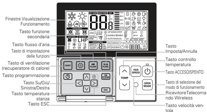
**Finestre Visualizzazione Funzionamento:** Mostra lo stato di funzionamento e le impostazioni
