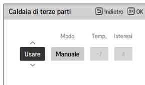
Se lo stato della presente funzione è “Usare”, sarà possibile scegliere la modalità di controllo della caldaia, Auto o Manuale.
