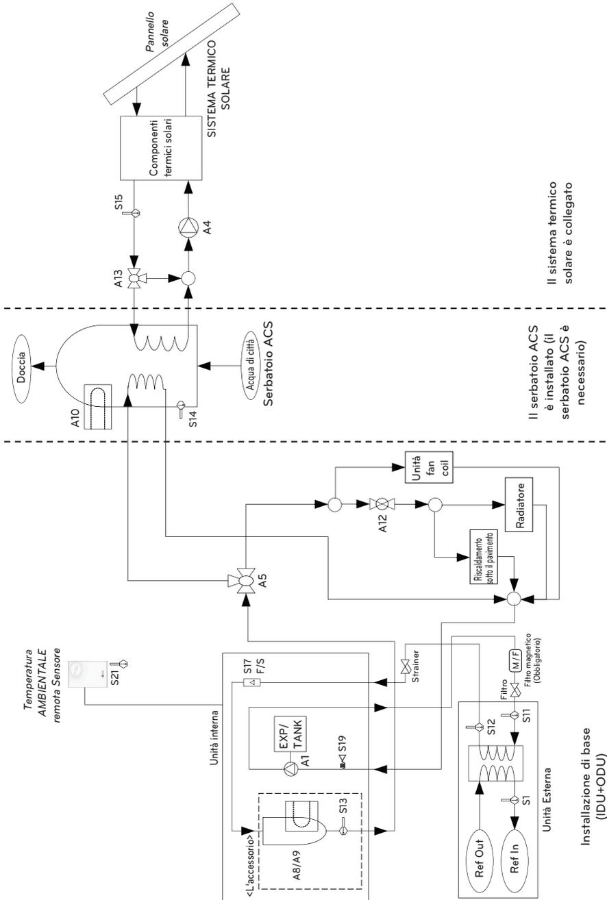
Il serbatoio ACS è installato (il serbatoio ACS è necessario)
