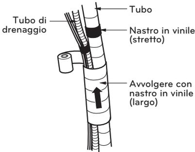
Effettuare la formazione del tubo avvolgendo il cavo di collegamento e il tubo del refrigerante (fra l'unità interna e l'unità esterna) con materiale termico isolante e fissarlo con due tipi di nastro in vinile.
