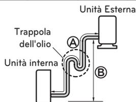
Una trappola è necessaria quando l'unità esterna è installata in una posizione più alta dell'unità interna.
