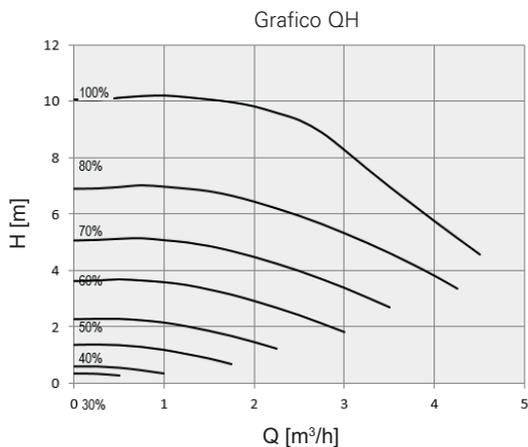
Test delle prestazioni basato sullo standard ISO 9906 con pre-pessione pari a 2 bar e temperatura del liquido di 20 °C.
