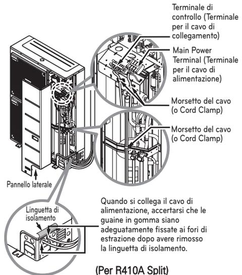
**Passo 3.** : Utilizzare i morsetti del cavo per impedire spostamenti indesiderati del cavo di alimentazione e del cavo di collegamento.
