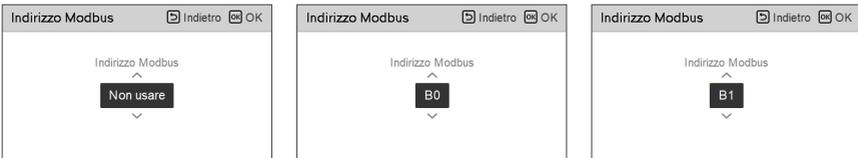
In questa funzione vi sono 2 opzioni, indirizzo Modbus e unità. Attivando l'opzione indirizzo Modbus, si sceglie un indirizzo (B0 o B1) o non lo si utilizza. Quindi si imposta la porta e la specifica nella gamma di 0000.0~9999.9 [impulso/kWh] come mostrato nell'immagine di seguito.
