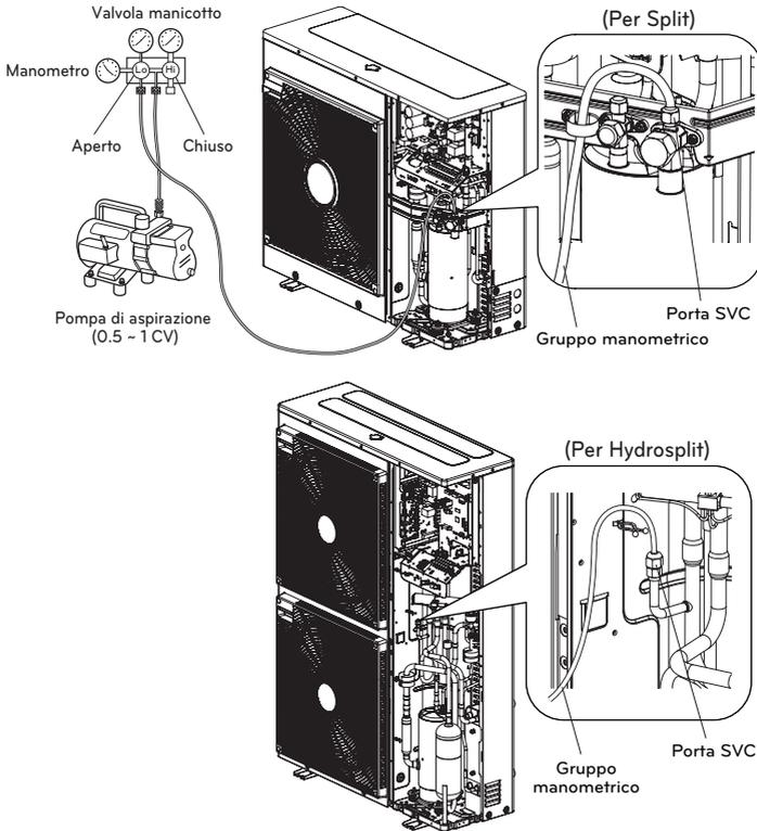
Quando si seleziona una pompa di aspirazione, è necessario sceglierne una che sia capace di raggiungere 0.2 Torr di aspirazione finale. Il grado di aspirazione è espresso in Torr, micron, mmHg e Pascal (Pa). Le unità sono correlate come di seguito:
