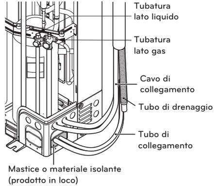
**Procedura di cablaggio per il cavo di alimentazione e il cavo di collegamento**
