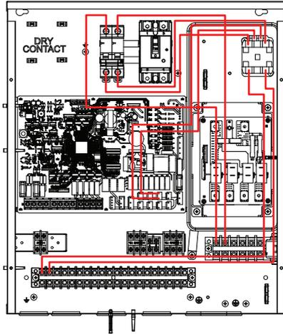
Riscaldatore di riserva per il modello 3Ø
