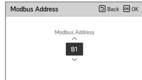
In questa funzione vi sono 2 opzioni, indirizzo Modbus e unità. Attivando l'opzione indirizzo Modbus, si sceglie un indirizzo (B0 o B1) o non lo si utilizza. Quindi si imposta la porta e la specifica nella gamma di 0000.0~9999.9 [impulso/kWh] come mostrato nell'immagine di seguito.
