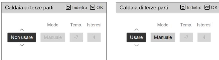
Se lo stato della presente funzione è "Usare", sarà possibile scegliere la modalità di controllo della caldaia, Auto o Manuale.
