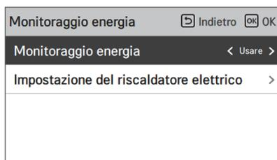
Se viene utilizzato il riscaldatore dell'unità, la potenza del riscaldatore può essere calcolata dopo aver impostato le informazioni del riscaldatore sul telecomando
