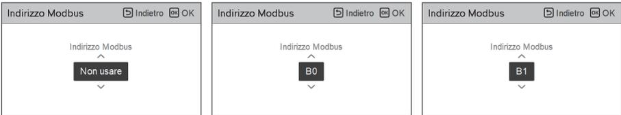
Ci sono 2 opzioni, indirizzo modbus e unità, in questa funzione. Attivando l'opzione indirizzo modbus, si sceglie un indirizzo (B0 o B1) o non si usa. Quindi, impostare la porta e le specifiche nell'intervallo 0000.0 ~ 9999.9 [impulso / kWh] come mostrato nella figura seguente.
