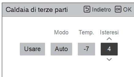
Come mostrato sopra, dopo che ogni impostazione è stata completata in modalità installatore, l'opzione di caldaia di terze parti è attivata nella lista delle funzioni.
