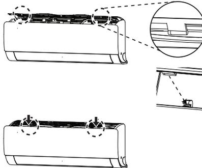
4. Controllare i lati della griglia frontale per assicurarsi che il filtro dell'aria sia montato correttamente.
