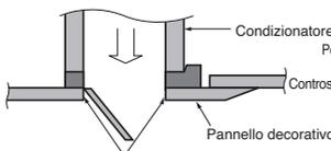
Inserire qui l'elemento isolante, facendo attenzione a evitare perdite d'aria fresca.
