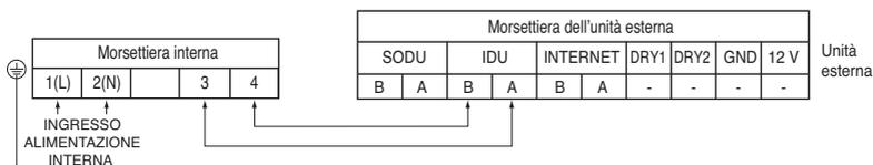
※ Posizione di misurazione del valore resistivo per un corretto collegamento del cablaggio.
