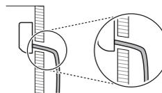
Esempio di una errata installazione del tubo di scarico
