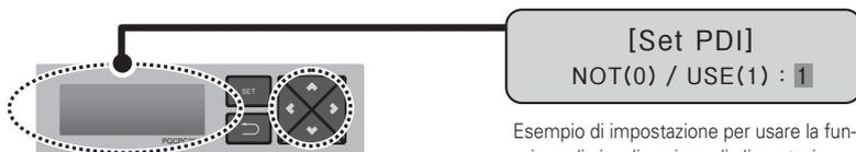
Esempio di impostazione per usare la funzione di visualizzazione di alimentazione
