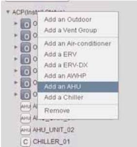
Per aggiungere una AHU, cliccare tasto destro, e aggiungere tramite il menu a discesa. Quando si preme il tasto [Add an AHU] nel menu a discesa, l'AHU verrà aggiunta. L'AHU è aggiunta indipendentemente senza entrare nel gruppo di unità esterna o ventilatore/ gruppo di tipo raffreddamento diretto.
