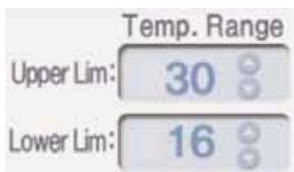
Impostare il limite massimo/minimo di temperatura all'interno quando è installato il condizionatore d'aria.
