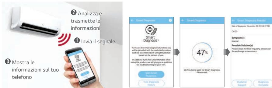
Quando il modello non è dotato di Wi-Fi integrato, la diagnosi avviene tramite segnale sonoro, LG ThinQ e comando a infrarossi (IR).
