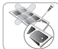
Non toccare la superficie del vetro o la cornice del modulo dopo l'installazione. In caso contrario sussiste il rischio di lesioni o morte.
