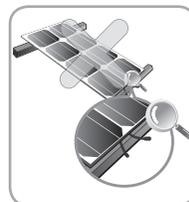
Non riconnettere o riparare il cavo della scatola di giunzione. Ciò potrebbe produrre scintille o causare scariche elettriche.
