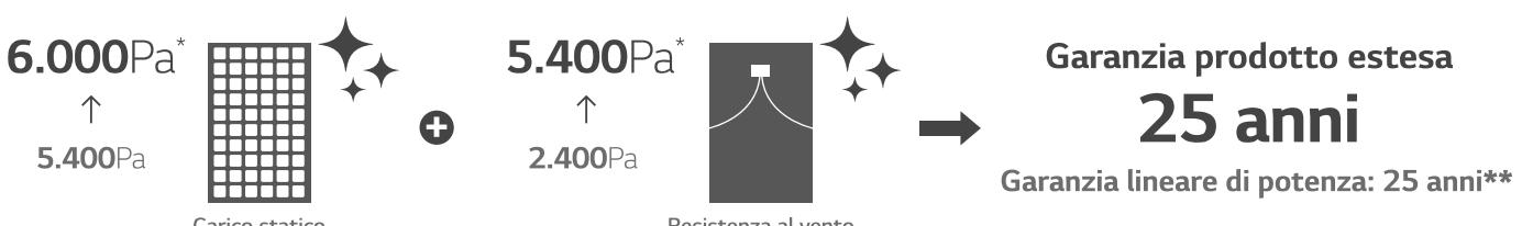
\*Il modulo è completamente conforme alle nuove procedure di test IEC 61215-2: 2016 che hanno confermato 5.400 Pa di carico frontale e 4.000 Pa di carico posteriore. LG ha effettuato test interni per confermare 6.000 Pa carico frontale e 5.400 Pa carico posteriore anche con le nuove norme IEC 61215-2: 2016. Ulteriori test sono in corso. A meno che questi test non risultino diversamente, LG conferma 6.000 Pa/5.400 Pa
