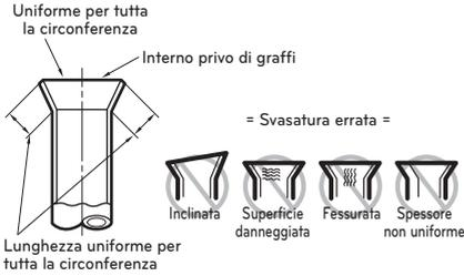
**Collegamento del tubo di installazione e del tubo flessibile di scarico all'unità interna.**
