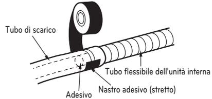
**Avvolgere il materiale isolante attorno alla parte di collegamento**
